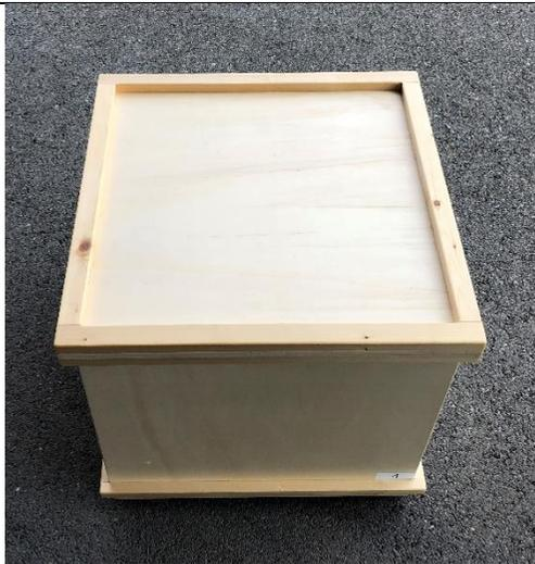
Legt den Deckel auf die Kiste. Passt dabei auf, dass der Deckel richtig aufliegt. Dies ist nur in einer Ausrichtung korrekt! Wichtig ist auch, dass der Deckel mit der Seite des dickeren Rands nach oben liegt!
