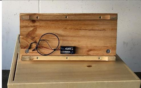
Dreht das Modell auf die Seite und setzt anschließend die beiden Batterien ein. Achtet dabei auf die korrekte Ausrichtung der Batterien. Sowohl die Batterien als auch die Batteriehalterung sind entsprechend markiert!
