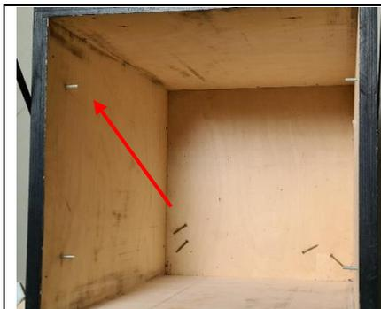
Setzt die kleine Kiste auf die große Kiste. Setzt dazu die Schrauben mit den Flügelmuttern ein und befestigt damit das Ablagebrett.
