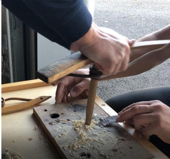
Variante 1: Holz machen mit dem Holzstab durch Reibung: Legt die Holzplatte auf die Kiste. Wickelt anschließend das Band des Bogens um den Holzstab und setzt oben drauf den Holzstab. Wichtig ist, dass dabei das Band nicht über Kreuz ist, ansonsten könnt Ihr keine Drehbewegung erzeugen.
